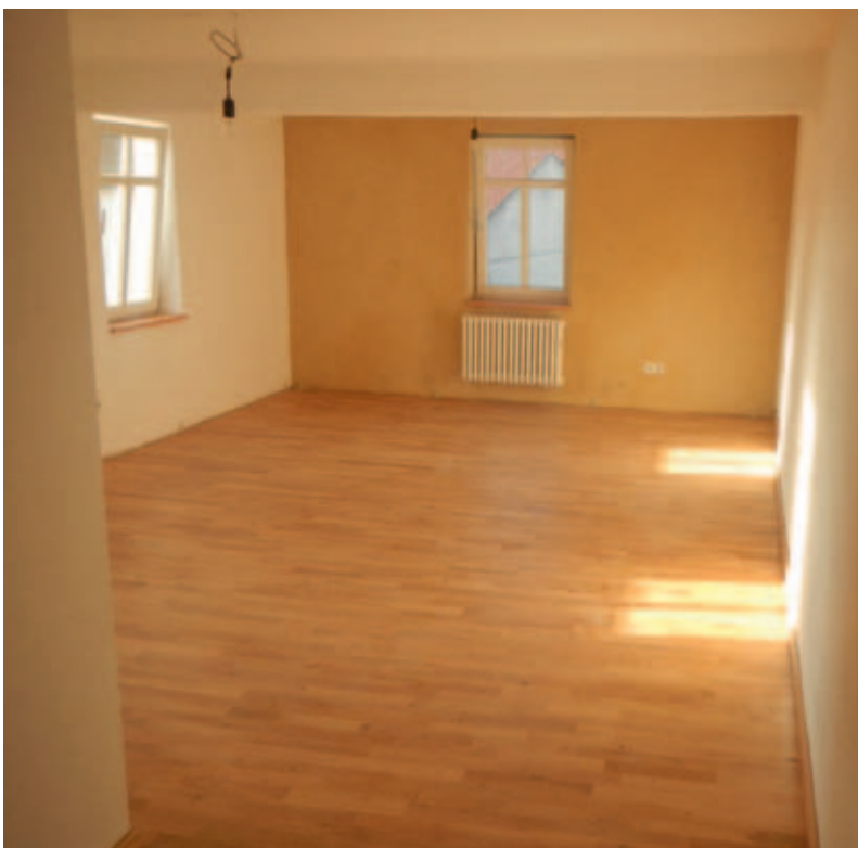
Verwendung diffusionsoffener Materialien beim Innenausbau: z.B. Holzdielen, Lehmputz
